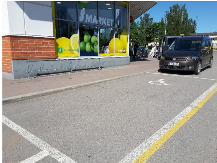
Kaupan edessä on LE-autopaikka, mutta sen vieressä on jyrkkä reunatuki. Pyöräteline on kulkureitillä.
